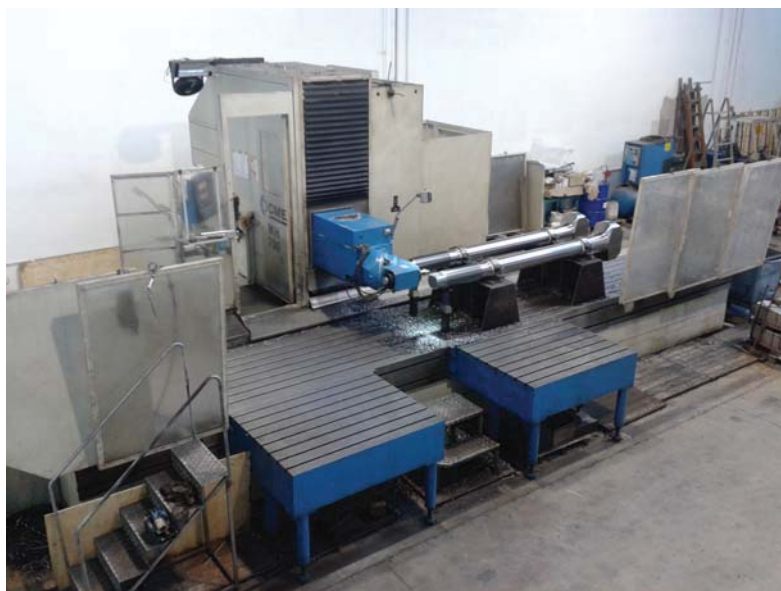
Lavorazioni steli tensionatori in acciaio 39NiCrMo3 UNI 7845/78
