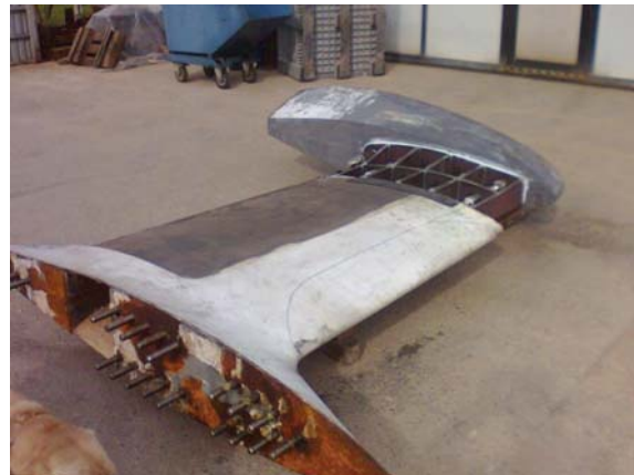
Modifica del profilo del bulbo e della deriva di un'imbarcazione lg 15 mt. Peso particolari T 3.3
