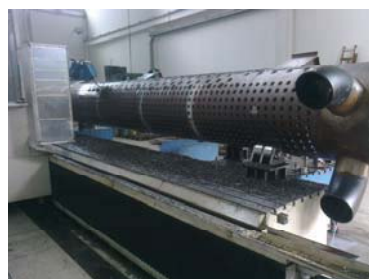
Lavorazioni di corpi caldaia settore energetico: dimensione particolare cilindro diametro 1000 lunghezza 13.000 peso Kg 9000
