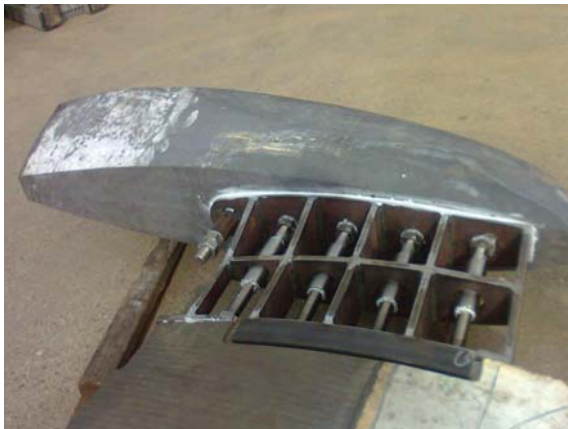
Modifica del profilo del bulbo e della deriva di un'imbarcazione lg 15 mt. Peso particolari T 3.3
