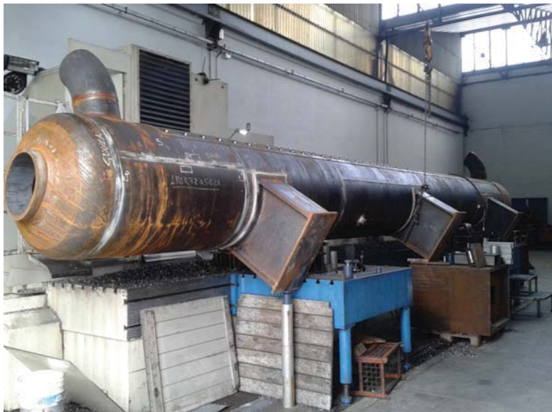
Lavorazioni di corpi caldaia settore energetico: dimensione particolare cilindro diametro 1000 lunghezza 13.000 peso Kg 9000
