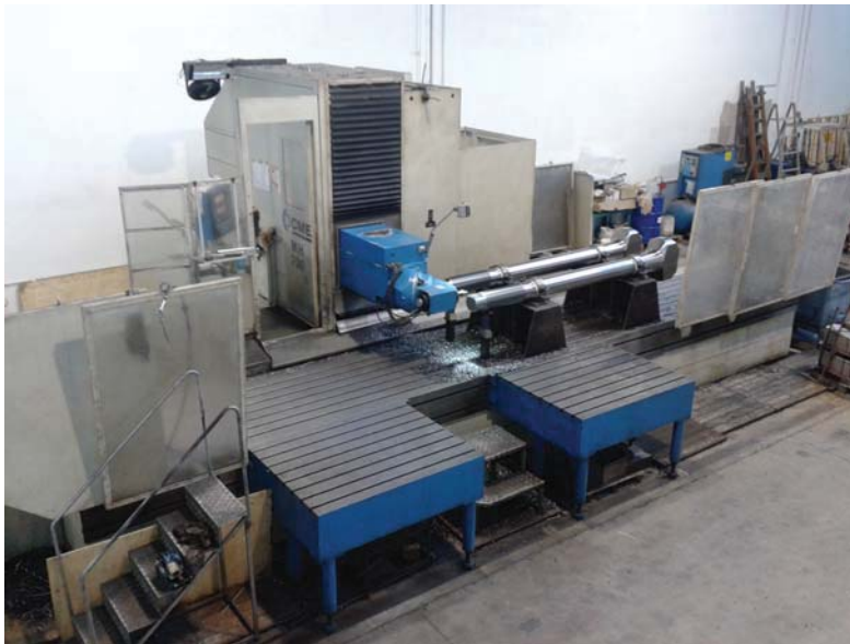
Lavorazioni steli tensionatori in acciaio 39NiCrMo3 UNI 7845/78
