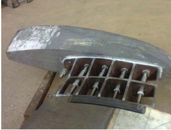
Modifica del profilo del bulbo e della deriva di un'imbarcazione lg 15 mt. Peso particolari T 3.3
