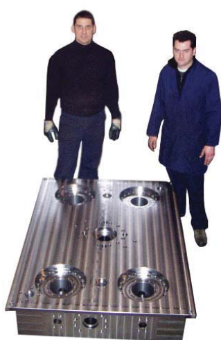
Basamento di grosse dimensioni per pressa stampaggio gomma - peso Kg 4200
