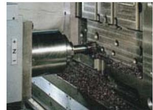
Montante di stampo in fase di fresatura
