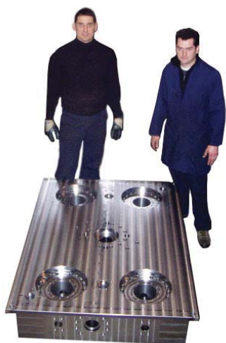
Basamento di grosse dimensioni per pressa stampaggio gomma - peso Kg 4200
