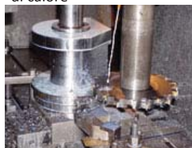
Fase di lavoro matrice per curvatura profili
