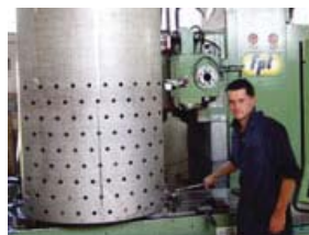
Foratura scambiatore di calore
