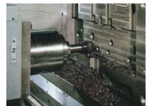
Montante di stampo in fase di fresatura
