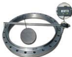
Flangia tornita con filettatura M850 x 4
