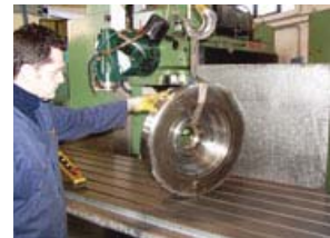
Fase di lavoro: ruota del carrello ferroviario
