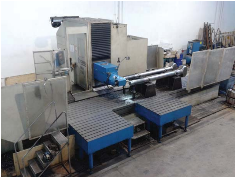
Lavorazioni steli tensionatori in acciaio 39NiCrMo3 UNI 7845/78
