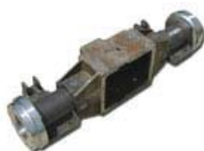
Semiassie con scatola differenziale elettrosaldato
